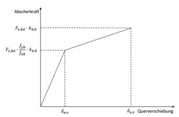
**Bild 4** Abscherkraft-Verformungslinie für Schrauben im Brandfall [4] Shear force displacement diagram for bolts in fire [4]
