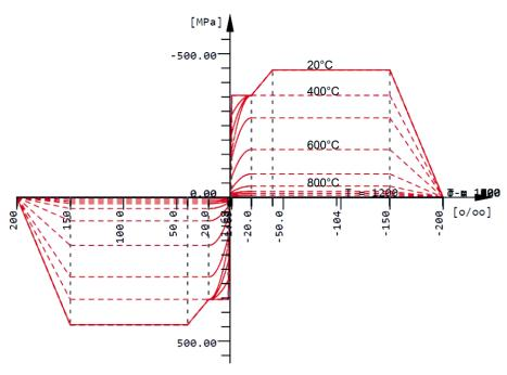
Bild 2 Temperaturabhängiges Werkstoffgesetz Baustahl S355 [4]
