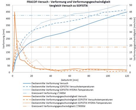
3ild 9 Validierung mit dem FRACOF-Versuch, Vergleich des Verformungsverhaltens in Deckenmitte [4] Validation with FRACOF test, comparison of deformation behaviour in the middle of the slab [4]
