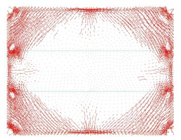
Bild 8 Validierung mit dem FRACOF-Versuch, Hauptspannungen an der Deckenoberseite bei 120 min [4]
