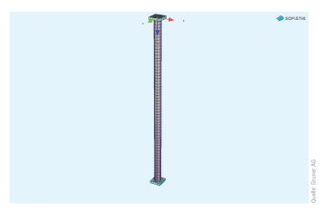
Bild 10 Statisches Modell einer Stahlstütze in SOFiSTiK Structural model of a steel column in SOFiSTiK
