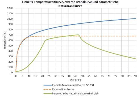
**Bild 1** Temperaturzeitkurven für die Bemessung im Brandfall [4] Temperature time curves for structural fire design [4]
