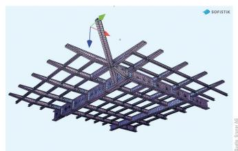
**Bild 12** Statisches Modell eines Stahlträgerrosts in SOFiSTiK, Teilsystem mit Symmetriebedingungen
