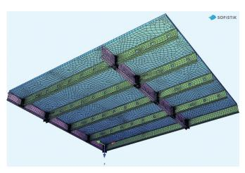
Bild 13 Statisches Modell eines Verbunddeckensystems mit Stahlträgern in SOFiSTiK, Teilsystem mit Symmetriebedingungen [4]
