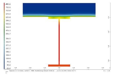
**Bild 6** Temperaturen in der thermischen Querschnittsanalyse [4] Temperatures in thermal section analysis [4]
