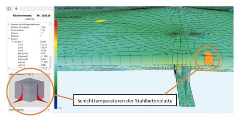
**Bild 7** Übernahme der Temperaturen aus dem thermischen in das mechanische SOFiSTiK-Modell [4] Transfer of temperatures from the thermal to the mechanical SOFiSTiK model [4]
