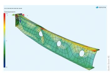
**Bild 11** Statisches Modell eines Stahlträgers in SOFiSTiK (verformt, halbes System)
