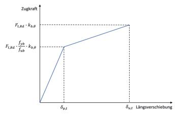
Bild 3 Zugkraft-Verformungslinie für Schrauben im Brandfall [4]
