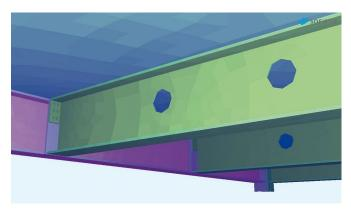
**Bild 5** Erweitertes Finite-Elemente-Modell einer Verbunddecke mit Stahlträgern und Anschlüssen in SOFiSTiK [4]
