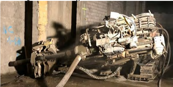
Abbildung 21: Ankerbohrgerät mit angeschlossenem Preventer.
